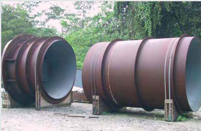
Blindage du puits - Blindaje del pozo
